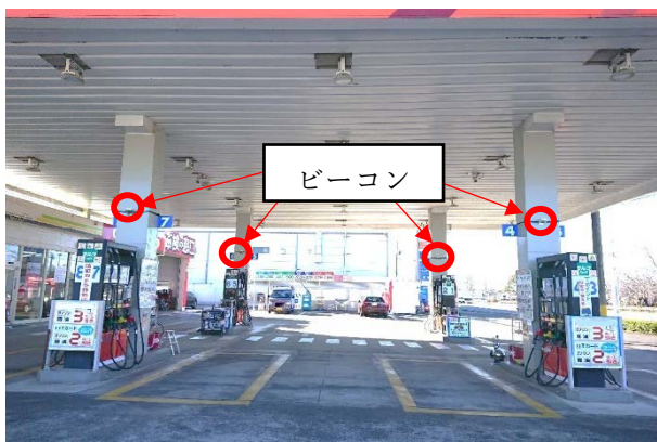
図10 ビーコン設置位置 (大規模施設)
