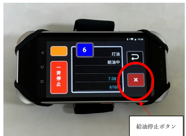
図3 可搬式の制御機器 (給油中)
